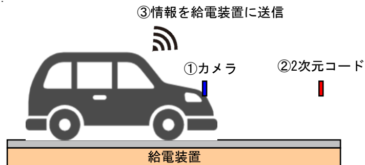
図 3.1.2-9 イメージセンサーによる給電制御のイメージ
