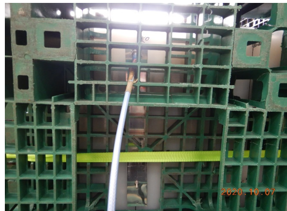
写真1.1-8 試験体への接続コネクタ取付状態
