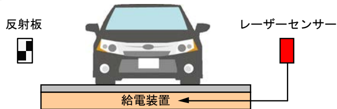
図 3.1.2-24 イメージセンサー概念図
