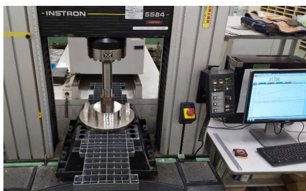
写真2.1-2 雨水浸透材の弾性係数測定状況
