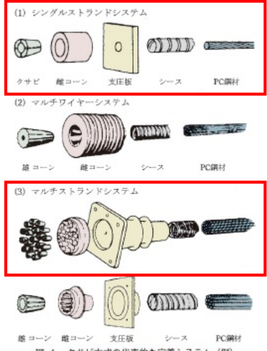
図-1 クサビ方式の代表的な定着システム (例) フレッシュマンのためのPC講座 (増補改訂版) より
