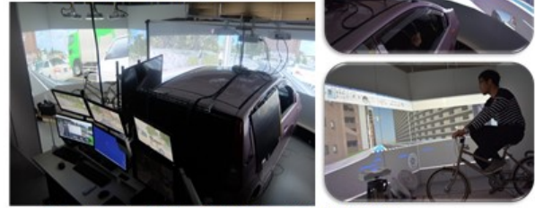
図-2.1 広視野型協調型サイクルシミュレータ (徳島大学)
