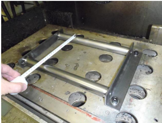
(a) 台座に設置した支点（支間長 200mm）
