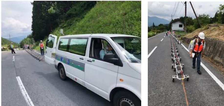
写真-2 ハイブリッド点検の様子（右：FWD 試験車両と計測台車 左：牽引式電気検層）
