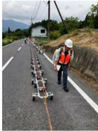
写真上： FWD試験 車両に牽 引される 探査装置。 写真右： 牽引式電 気探査装 置。
