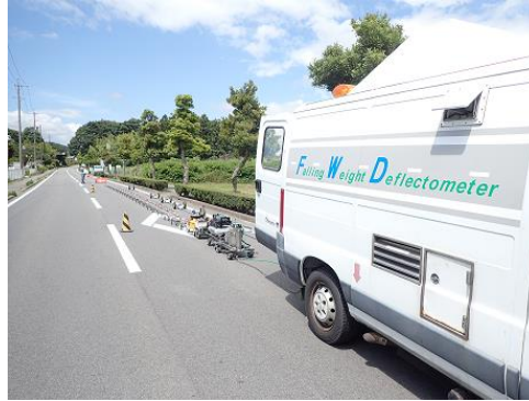
写真上： FWD試験 車両に牽 引される 探査装置。 写真右： 牽引式電 気探査装 置。
