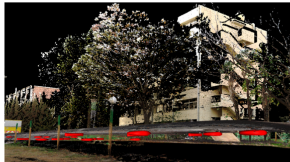
実物大試験道路の点群+空洞三次元合成画像
