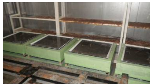
(a)スケーリング試験状況
