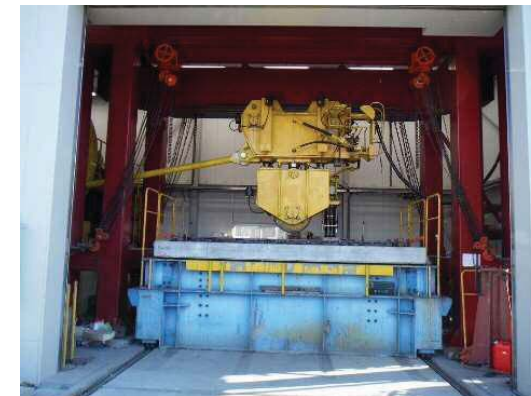
輪荷重走行試験実施状況
