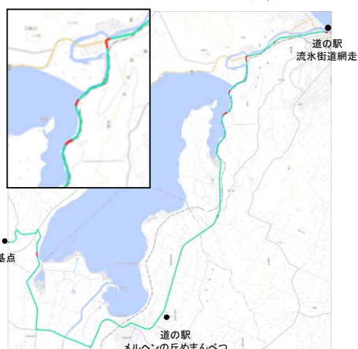
図 11月10日午後自動運転システムで走行した例（赤線区間はオーバーライド区間）
