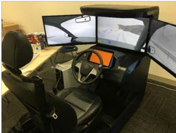
図 UC-win/Road Drive Simulator の外観と DS で再現した冬期路面の映像
