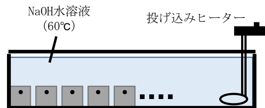
図 2.5 ASR 促進試験の模式図
