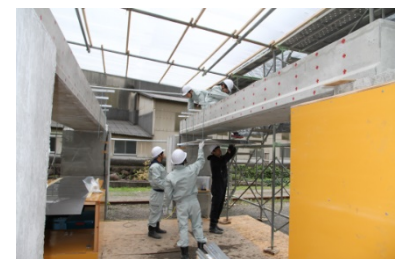
写真 2.1 電食試験・計測を行った RC 梁とその設置状況
