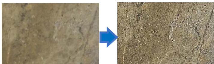
図 3.2 画像のシャープ化によるマッチングのための特徴明確化
