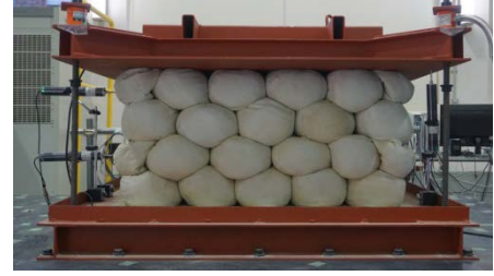
土のう積層体の振動台加振実験
