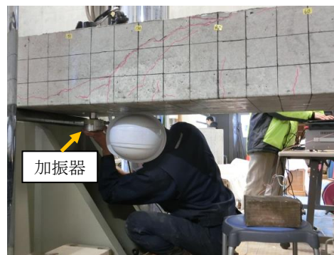
写真-2.1 局所振動試験の状況 (左：上面測定、右：下面測定)
