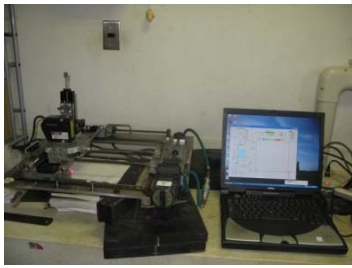
レーザーシステム 基準距離80mm, 最小表示単位0.01μm
