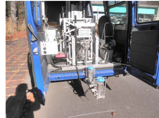
FWD試験状況
