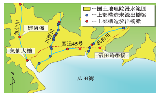
図—5 陸前高田全体の橋梁被害と浸水範囲
