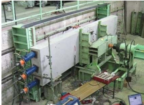
写真3 継手部の曲げ試験
