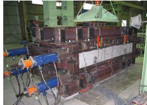
写真4 継手部のせん断試験
