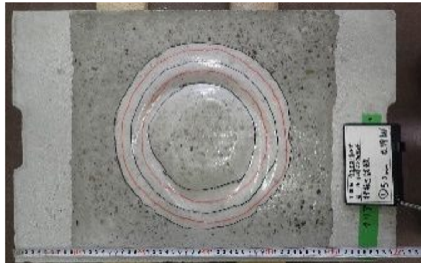
写真 3.5 視認性試験の供試体例（押抜き試験後）
