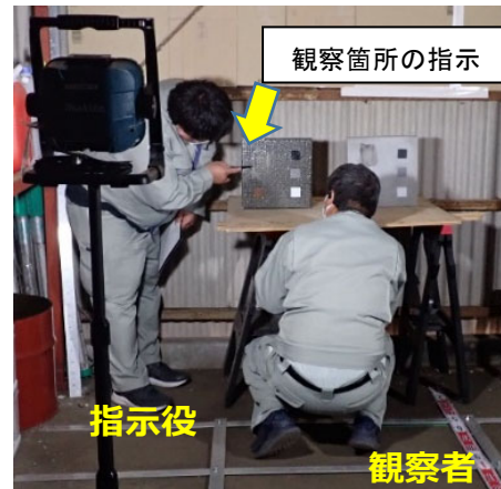
写真 3.3 覆工の模擬変状の視認状況
