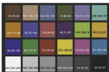
・ 真値とする実物カラーチャート (数字はRGB値・参考、右図も同様)
