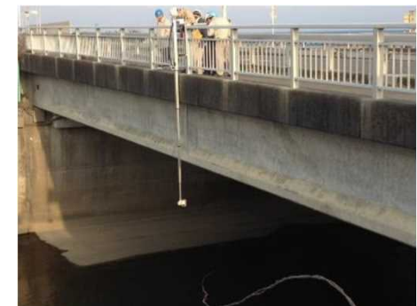
撮影した写真からひび割れ幅を測定
