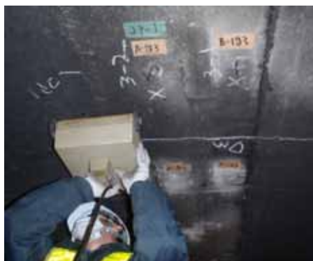
写真 電磁波レーダ探査装置を用いた覆工厚の調査状況
