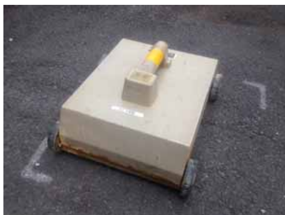
左: アンテナ部 右: コントローラ・波形表示部 写真 調査で使った電磁波レーダ探査装置一式
