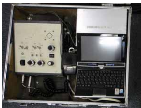
左: アンテナ部 右: コントローラ・波形表示部 写真 調査で使った電磁波レーダ探査装置一式
