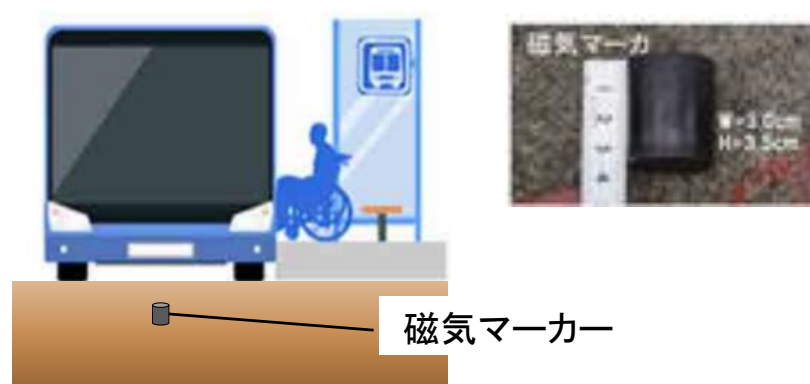
▲磁気マーカーによる自車位置特定による運行の補助
