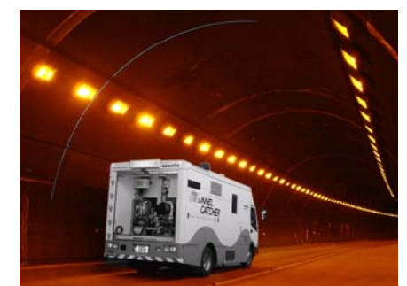
レーザーによる ひび割れの検出
