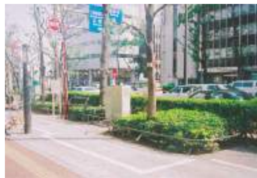
写真 5.10.6 道路占用物件はその都度個々に判断して位置や形状を決めるのではなく、全体として統一感をとることを心がける。歩道の中に植栽帯がある場合には、その中に配置するとすっきりする。
