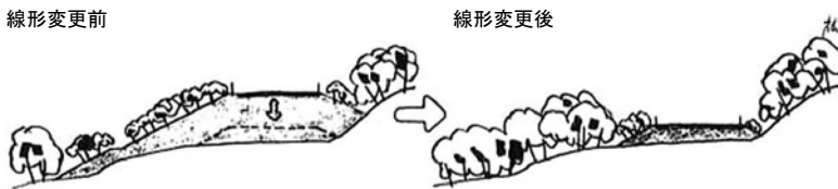
図 1.7 平面線形と縦断線形の変更によって大規模な土工を避けて自然環境への影響を回避している。
