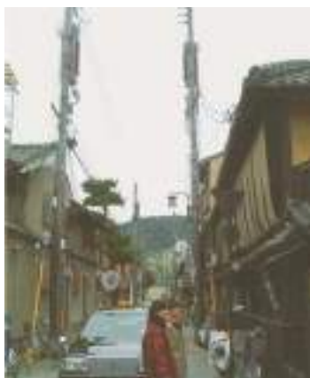
写真 5.15.5 無電柱化とともに路面や照明灯の整備と沿道建物整備が協力して行われている。直行する路地の電柱類にも配慮が見られるが、圧迫感は残る。
