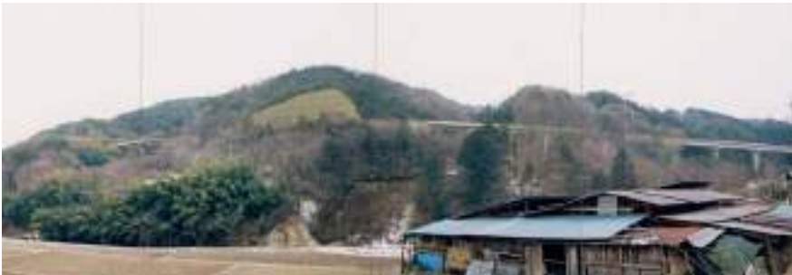
写真 2.3.6 フォトモンタージュの事例。現 地の写真に建設予定の道路構造 物等を、その位置や大きさを正 確に当てはめることで、将来景 観を予測する。再現性に優れる ため、プレゼンテーションに向 いている。
