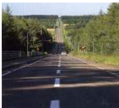
写真 3.2.6 等高線と直交する縦断線形を採用することによって、凹凸のある特徴的な丘陵のダイナミックな地形を意識させている。
