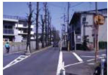
写真 5.11.12 余裕のない道路幅員に並木植栽が無理やり押し込められ、強剪定によってかろうじて生かされているが、植栽の効果は期待できない。
