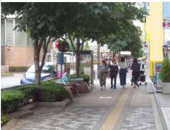
■ 植樹帯と一体的に整備された歩道部のベンチ
