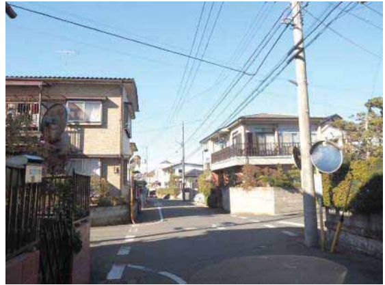
■同一交差点における複数の道路反射鏡を設置した例 高さ等が不揃いであり、乱雑な印象である
