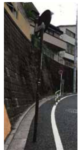
■支柱や鏡面の取付枠および背面にダークブ ラウンを採用している例 背景と対照的な色合いを採用
