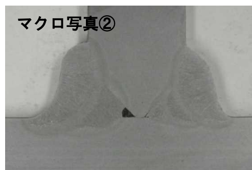
写真Ⅲ－2：勸進橋に用いられた製品の溶接不良の状況
