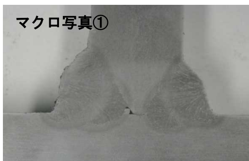
写真Ⅲ－2：勸進橋に用いられた製品の溶接不良の状況
