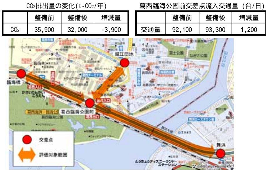
図8 交差点立体化事業によるCO 2 排出量の変化
