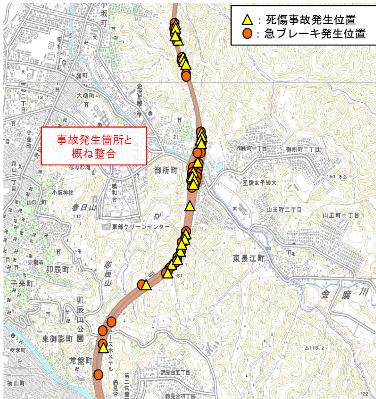
図 死傷事故と急ブレーキ発生箇所位置図 (石川県 国道159号今町JCT～鈴見)
