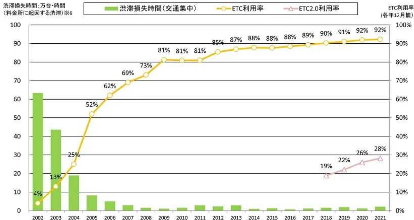
ETC利用率と料金所における渋滞損失時間(NEXCO東日本管内)
