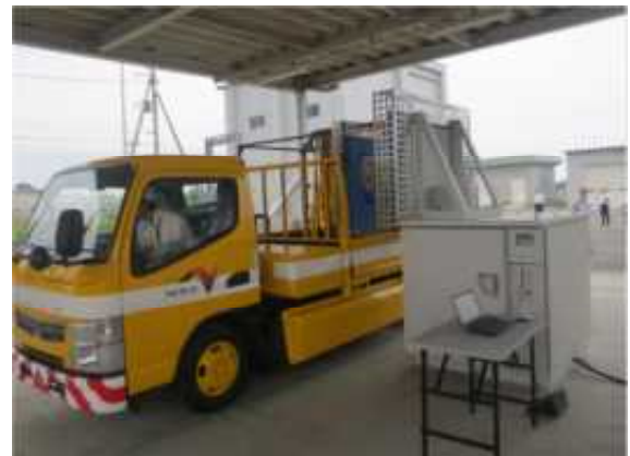
非接触給電装置での給電状況
