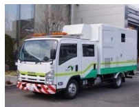
▲路面性状測定 高速走行でレーザー光線を投射し、路面のわだち揺れ・平坦性を調査
