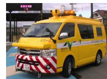
▲施設多機能測定 ETC設備・ハイウェイラジオ等の電界強度、道路照明等の照度等を測定
