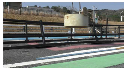
強度試験(重錘試験)
