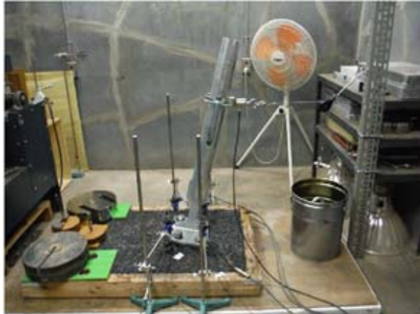
従来のアスファルト舗装に定着した場合の支柱傾倒メカニズムを検証 引張力が作用するアンカー周辺の舗装がめくれ上がった
