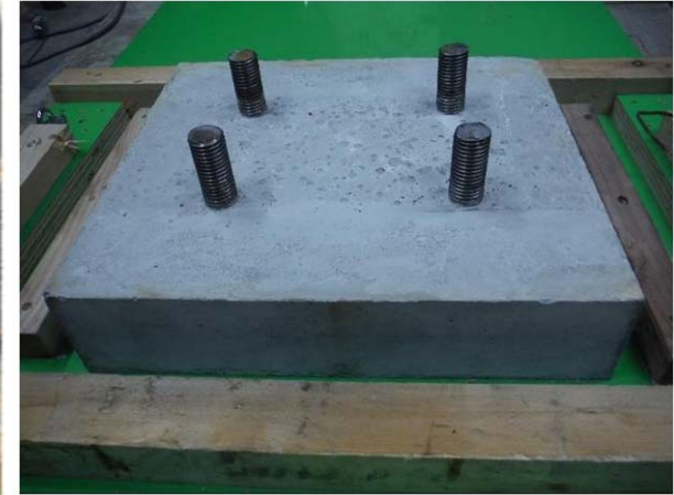
コンクリート基礎に定着した場合はアンカーの引抜き及びコンクリートのひび割れ等損傷は発生しなかった
