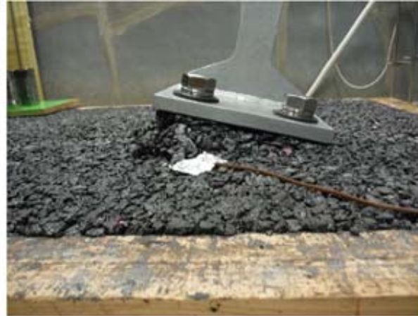
従来のアスファルト舗装に定着した場合の支柱傾倒メカニズムを検証 引張力が作用するアンカー周辺の舗装がめくれ上がった
