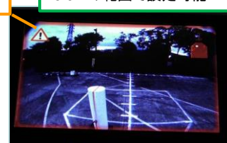
物体検知・警告技術 検知状況
