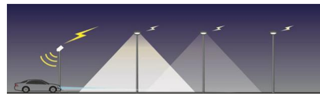
センシング技術により車両等を検知したときのみ点灯する照明
