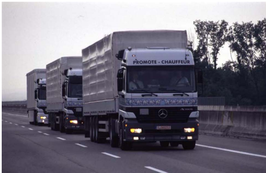
CHAUFFEUR 連結走行
