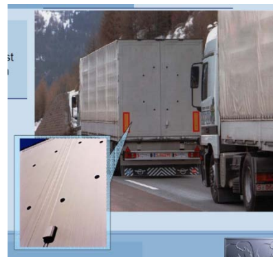
赤外線マーカによる車間距離維持と操舵制御 (イメージ)
