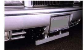
磁気式レーンマーカセンサ センサ装着状態 磁気マーカセンサ
