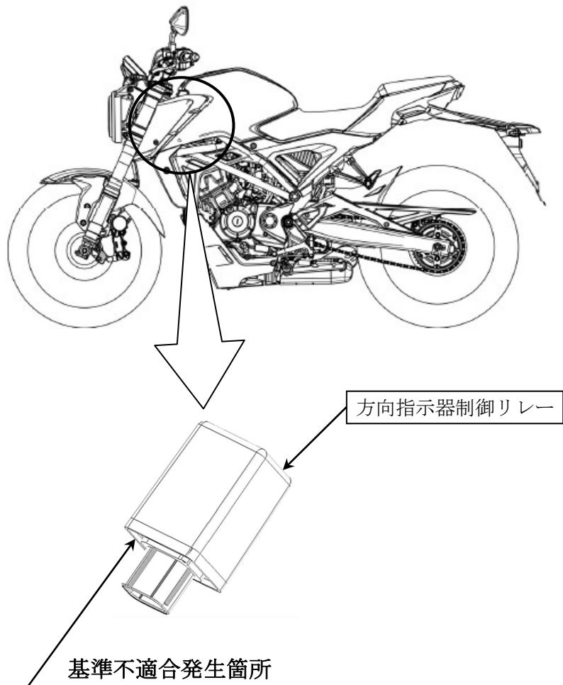
方向指示器を制御するリレーの内部回路が不適切なため、後部片側方向指示器が故障した際に、方向指示器のスイッチを故障側へ操作した後、故障していない側へ操作すると、故障していない側の前後方向指示器が速く点滅することがある。そのため、協定規則第53号の技術的な要件に適合しない。
