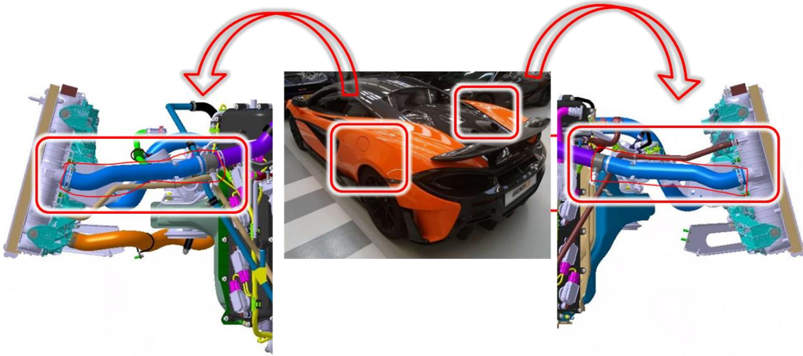
不具合の冷却水ホース
