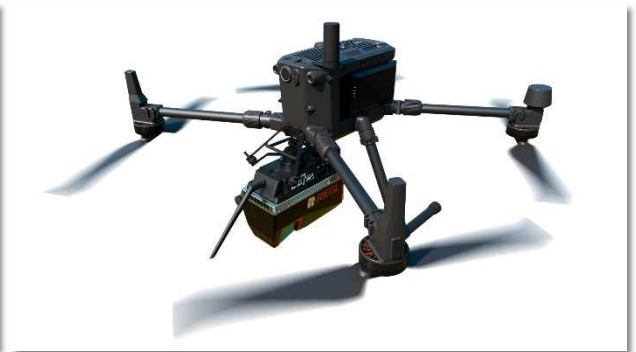
図-2 240万点/秒と超高速でレーザを照射する重量2.7kgのスキャナを搭載した汎用ドローン
