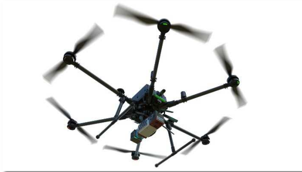
図-1 30万点/秒のレーザ照射能力をもちながら軽量（重量2.2kg）化されたスキャナ搭載の汎用ドローン
