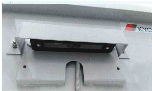
番号灯取付状態
