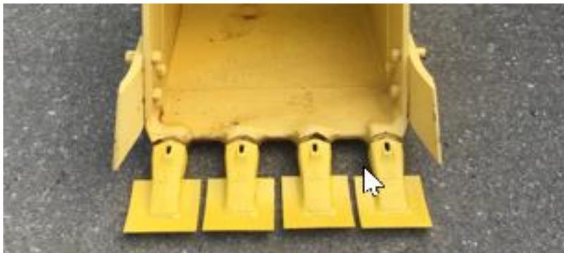
切削バックホーにクマンツメを装着し完成(4枚1セット)にしたところ。
