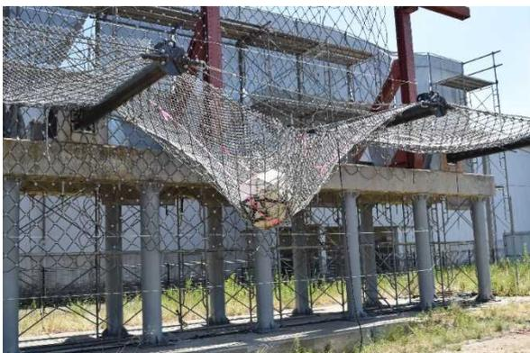
写真—2 落石実験の様子
