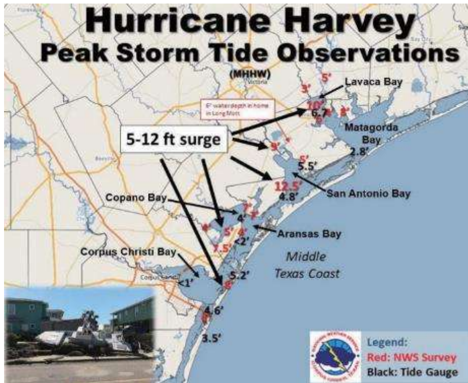
図 2.1.19 ハリケーン・ハービーで観測された高潮（黒字）と、NWS 調査による高潮（赤字）
