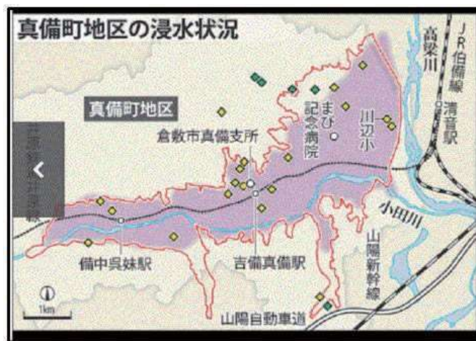
図 3.5.1 西日本豪雨による倉敷市真備町の洪水氾濫におけるハザードマップ（外郭線）と実績（陰影部）の浸水区域の比較
