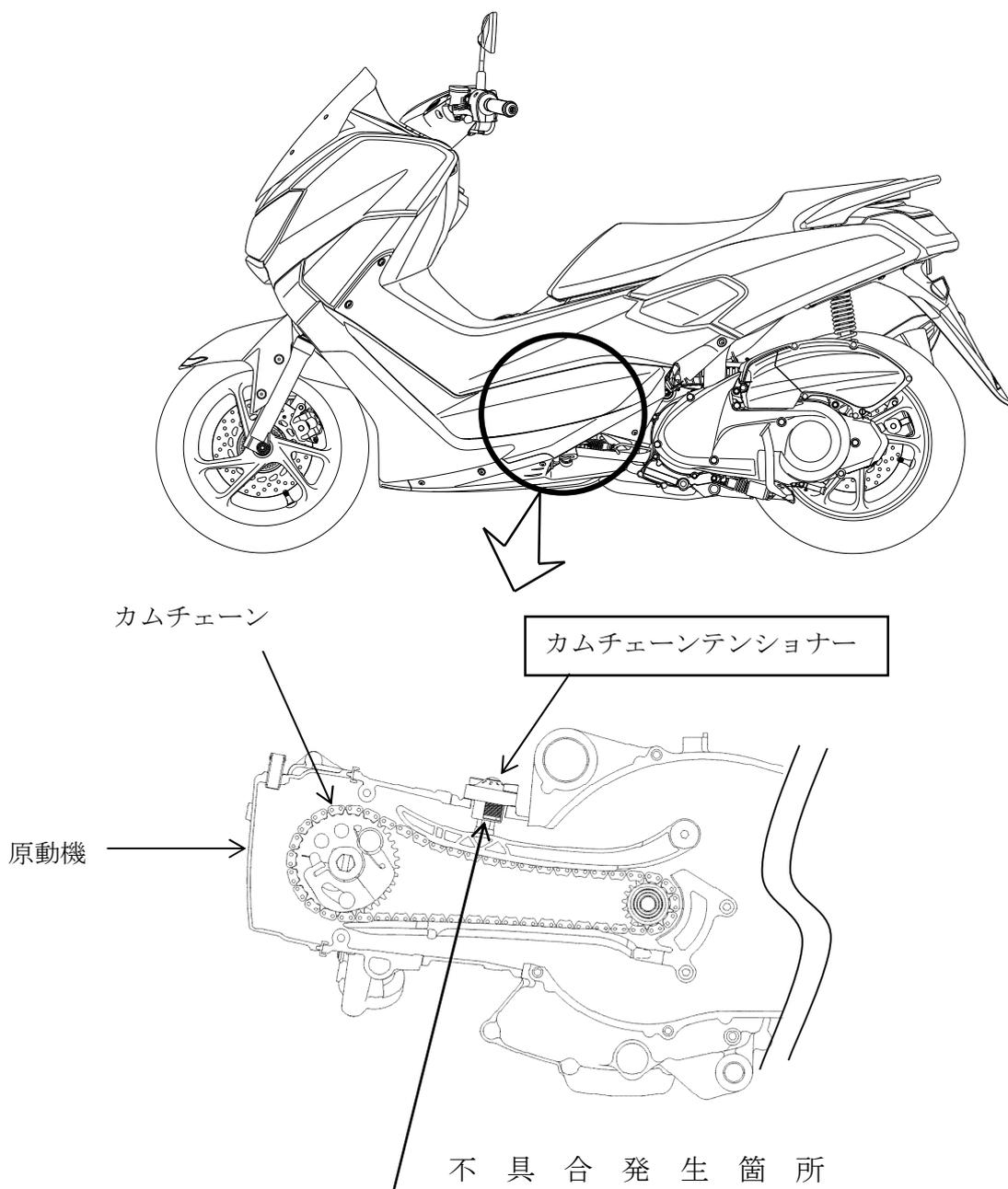
原動機のカムチェーンテンショナーにおいて、内部のスプリングの強度が不足しているため、カムチェーンの振れにより当該スプリングが破損するものがある。そのため、異音が発生し、最悪の場合、カムチェーンが外れてエンジンが停止して、再始動できなくなるおそれがある。
