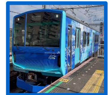
JR東日本の水素燃料電池試験車両HYBARI
