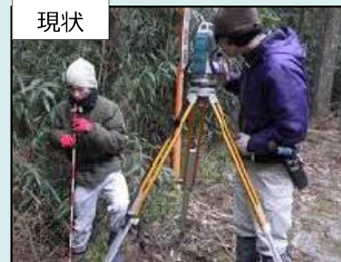
現状 現地に測量機器を設置し、土地の境界点の座標値を測量
