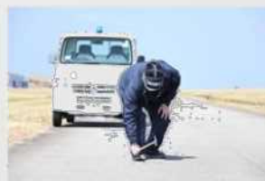
路面を叩いて行うキズ点検。履歴は写真と文書で記録していたが、HoloLens 2 を装着すれば、点検履歴が視界に表示される
