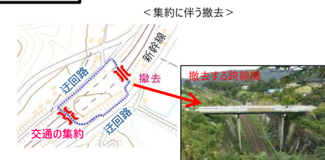
老朽化が進んだ跨線橋を撤去し隣接橋へ機能を集約
