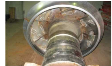
ポンプ羽根車の壊食状況
