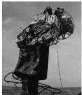
損傷した浮体式灯標
