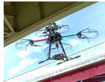
▲橋梁の損傷写真を撮影する技術
