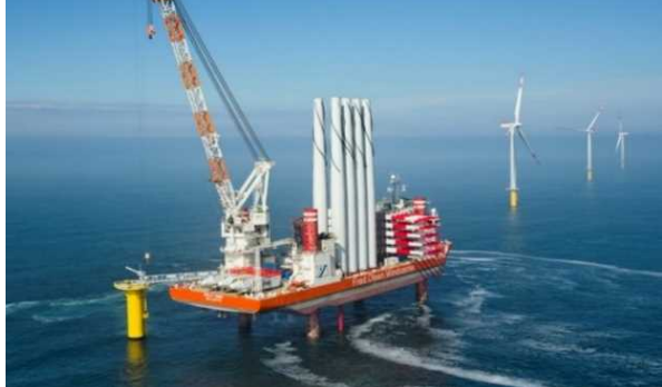
※SEPはSelf-Elevating Platformの略 自己昇降式作業船
