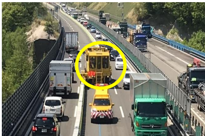
＜ロードジッパーを活用した対面通行規制の状況＞
