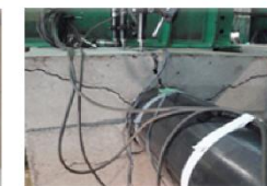
コンクリートと鋼管の実物実験
